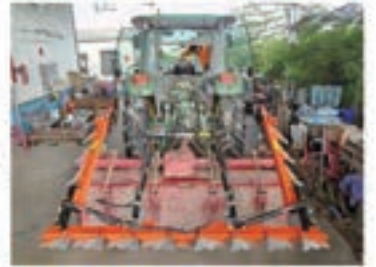
插秧/曳引機 改門字型整平器 IN 全鐵、HS 半白鐵、SU 全白鐵 1789 / 2012 / 2345 / 2678 / 2931
