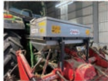
插秧/曳引機 改門字型整平器 IN 全鐵、HS 半白鐵、SU 全白鐵 1789 / 2012 / 2345 / 2678 / 2931
